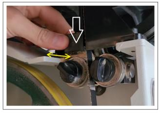
Schritt 2 Überprüfung und ggf. Anpassung der Schlittenposition. Sägezähne sollen axial frei zum Lagerrand hervorstehen.
