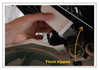
**Schritt 4**Tisch nach oben kippen und Schale wie abgebildet einsetzen.
