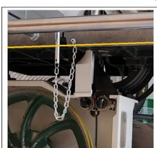
**Schritt 5**Tisch nach Einsetzen der linken Schale in waagrechte Position bringen
